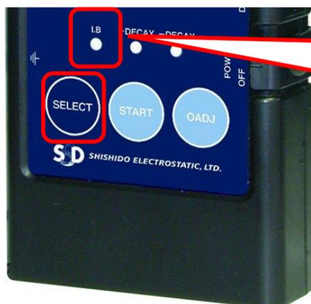
8、按 select 鍵選擇 I.B 模式(Ion balance)可單純測量靜電離子平衡度
